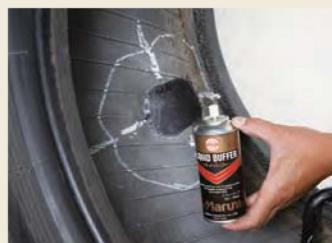
**20** Χρησιμοποιήστε υγρό στιλβωσής LIQUID BUFFER για να μαλακώστε τις ραβδώσεις του ελαστικού στη πλευρά προσκόλλησης.
