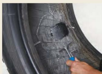
**21** Χρησιμοποιήστε μια ξύστρα για να αφαιρέστε τις ραβδώσεις του ελαστικού στη πλευρά προσκόλλησης.
