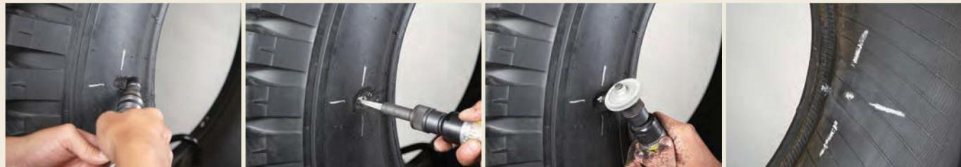
**1** Χρησιμοποιήστε ένα περιστροφικό εργαλείο στο εξωτερικό του ελαστικού για να απομακρύνετε τα κομμάτια του ελαστικού που έχουν τραυματιστεί.
