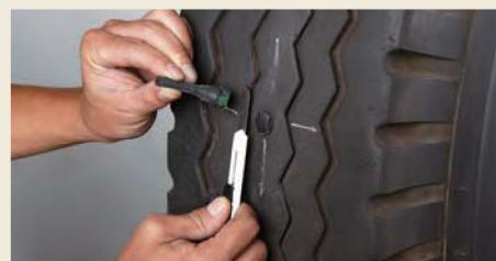
**16** Κόψτε τη καβίλια 2 με 3 mm που θρίσκετε πάνω από το ελαστικό . Χρησιμοποιήστε στεγανοποιητικό μπαλώματος SEALINER πάνω από το μανσόν . Η επισκευή είναι έτοιμη.
