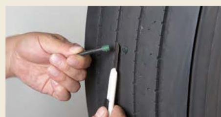
**16** Κόψτε τη καβίλια 2 με 3 mm που θρίσκετε πάνω από το ελαστικό . Χρησιμοποιήστε στεγανοποιητικό μπαλώματος SEALINER πάνω από το μπάλωμα . Η επισκευή είναι έτοιμη.
