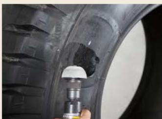
**18** Λιασίνετε τη μέχρι τώρα επισκευή με ένα χαμηλής ταχύτητας αεροτροχό ή κάπιο παρόμοιο εργαλείο.
