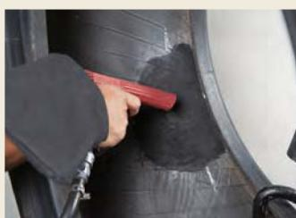
**23** Χρησιμοποιήστε ένα πιστόλι αναρρώφωσης για να απομακρύνετε τα υπολείμματα του ελαστικού.
