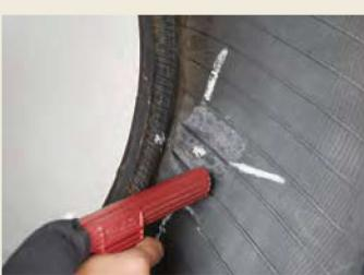
**6** Χρησιμοποιήστε πιστόλη αναρρόφησης για να απομακρύνετε τα υπολείμματα του ελαστικού.
